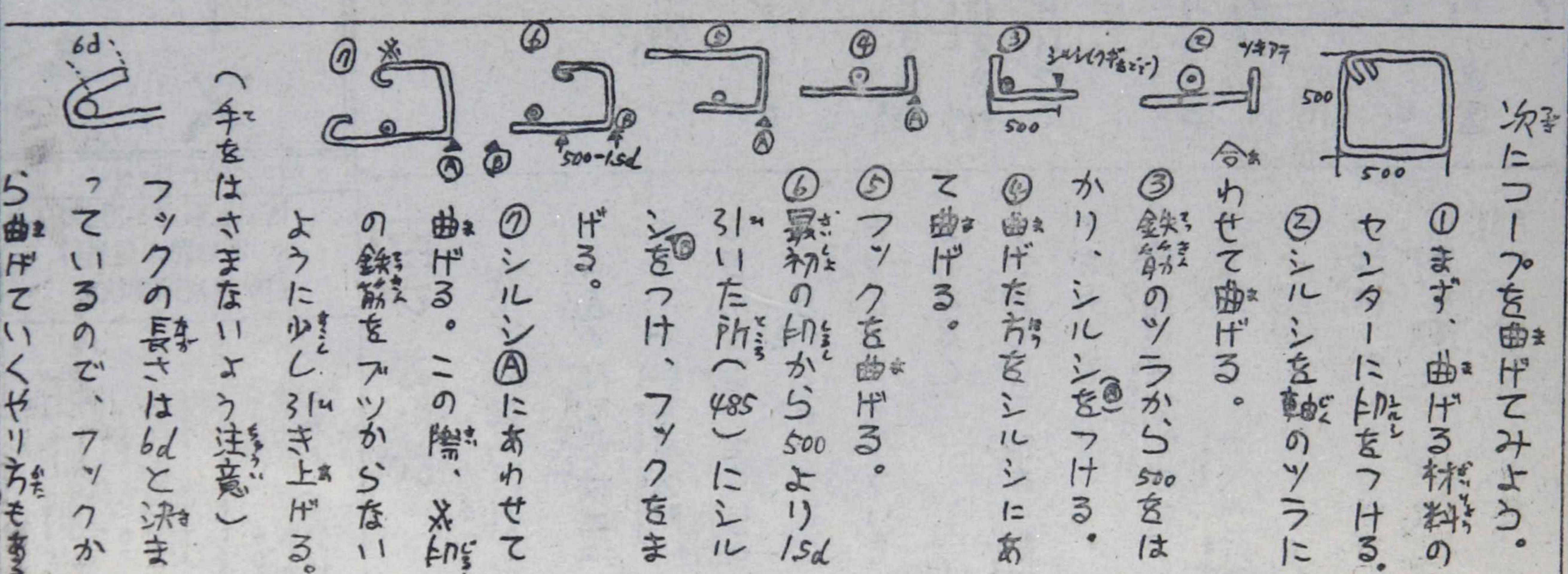
①まず、曲げる材料のセンターにトモフける。
